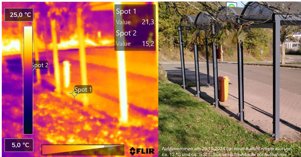
Abbildung 3-15 Thermografieaufnahme der Bushaltestellen der Realschule Plus Lauterecken 71
