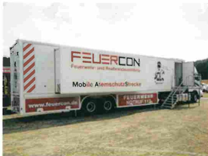
Die mobile Atemschutzstrecke der FEUERCON (MobAS) befindet sich in einem isolierten Sattelaufleger der durch beidseitige Ausschübe vergrößerbar ist. Durch den Ausbau der Anlage erfüllt diese die Vorgaben der FwDV 7 und DIN 14093.
